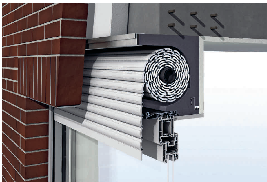
Pakto – Einbausituation HK 300/300 (RUI), Einsatz in zweischaligem (einschaligem) Mauerwerk. Abbildungen: Growe/Roltex.
