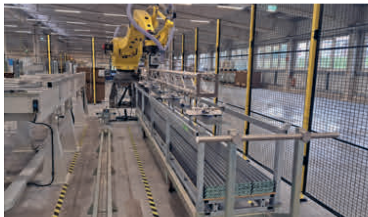
Das Ab stapeln der auf sechs Meter fertig geschnittenen Stabware erfolgt hochautomatisiert mithilfe eines Roboters.
