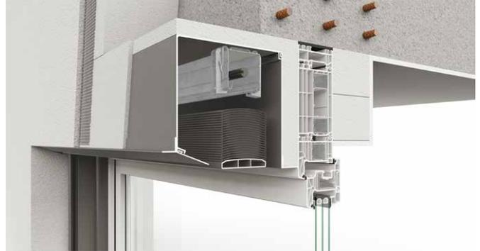
Einbausituation Raffstore Putzträgerkasten stranggepresst 20°
