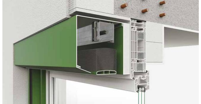
Einbausituation Raffstore Vorbaukasten stranggepresst 20°
