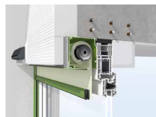
Putzträgerkasten 90° mit SOLAR-POWER-Modul und Montage-Einputzrahmen bauseits auf der Fassade montiert
