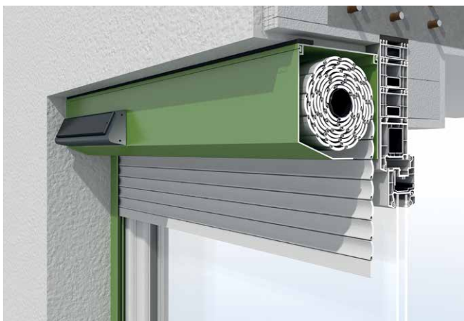
Vorbakasten 20° mit SOLAR-POWER-Modul auf der Blende montiert, Montage in der Laibung
