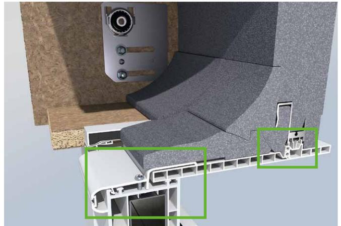
Variante 1 mit verstellbarer Lagerplatte
